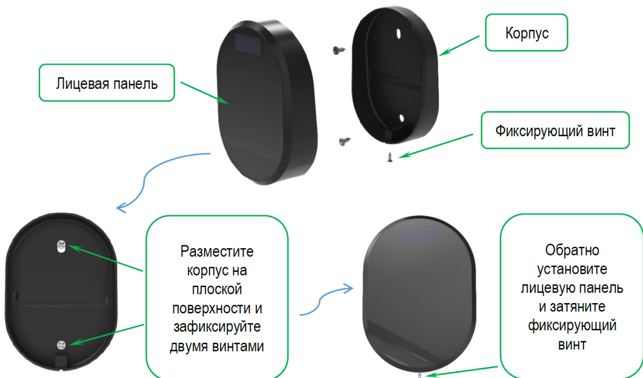
Рисунок 3 – Порядок установки кодовой панели
