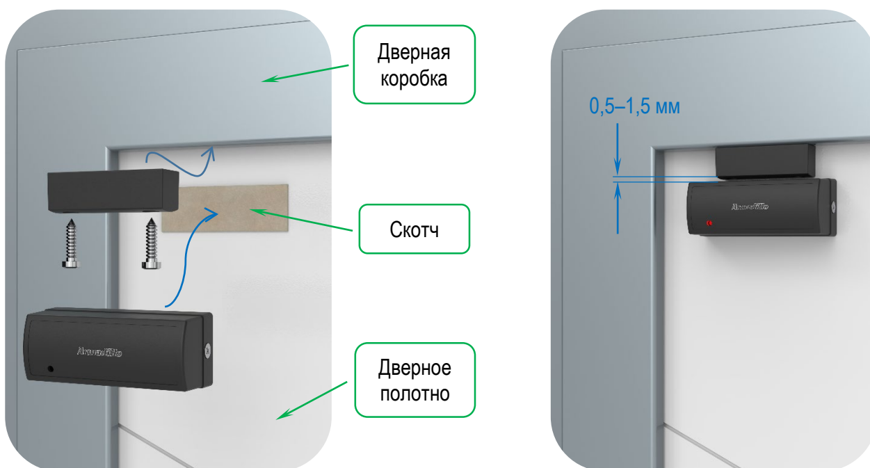
Рисунок 11 – Установка датчика положения
